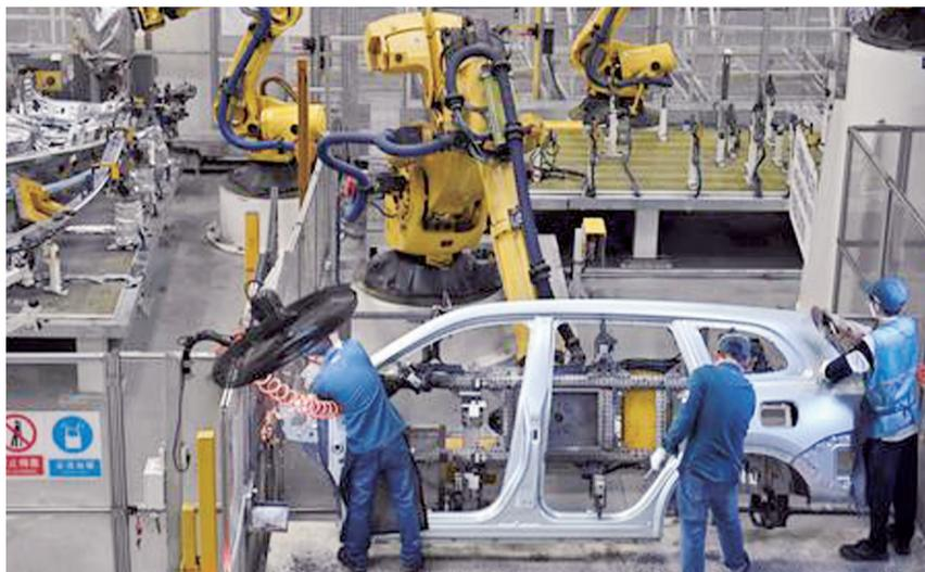
在位于沙坪坝区的赛力斯汽车凤凰智慧工厂焊装车间,机械臂正在进行焊装。
