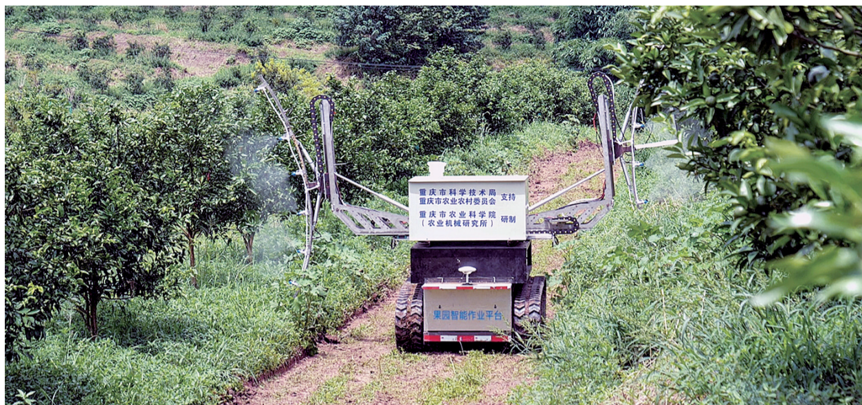
重庆市农业科学院自主研发的“对靶喷药机器人”自动巡回喷药杀虫
