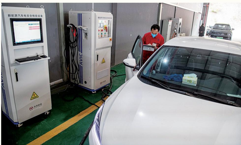
工人在新能源汽车检测线上对车辆进行安全检测
