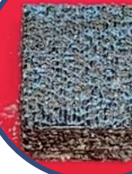
利用月壤3D打印系统打印的模拟月壤砖
