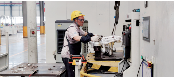
拓普汽车工人正在处理压铸出的全铝副车架
