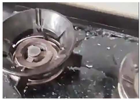
安装使用了某款燃气灶聚能环后发生爆裂 锅水需要3分钟左右，未加装聚能环烧水用时反而更短。
