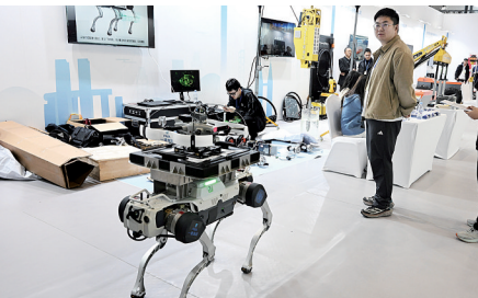
机器狗+无人机组合的巡查测绘机器人
