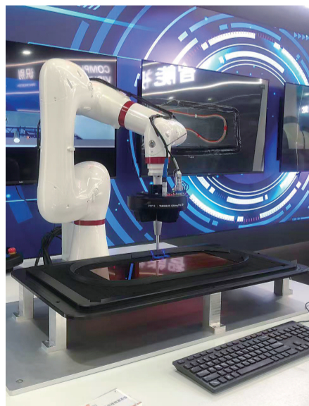
中科摇橹船的3D涂胶质量在线检测系统
