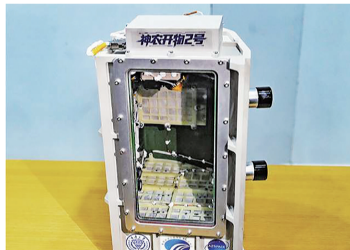
“神农开物2号”小型太空生态系统试验载荷
