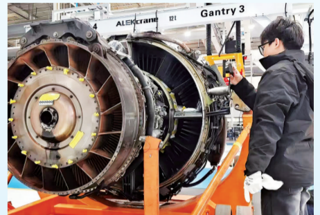
瑞航发维工程师正在对发动机进行进厂检查
